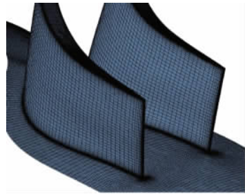
图 5 动叶壁面网格 Fig. 5 Rotor solid mesh
